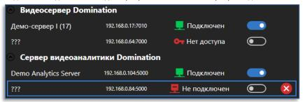
Для подключения сервера в столбце «**Управление**» нужно нажать на кнопку-переключатель подключения.
